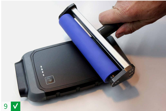
9 Druk de plaat stevig aan en rol na voor goede hechting van de plakfolie.
