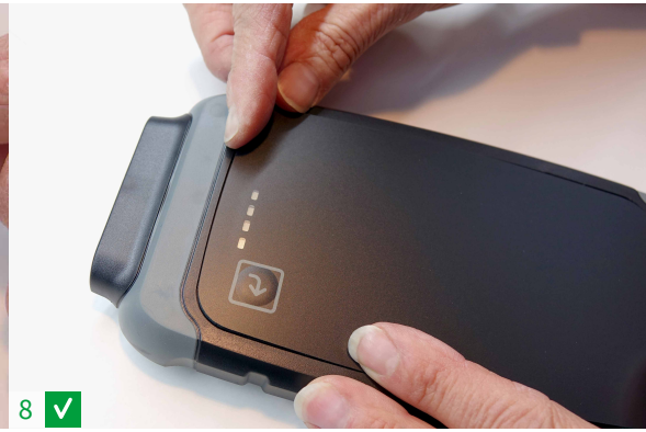
8 Plaats de achterkant voorzichtig op de behuizing.
